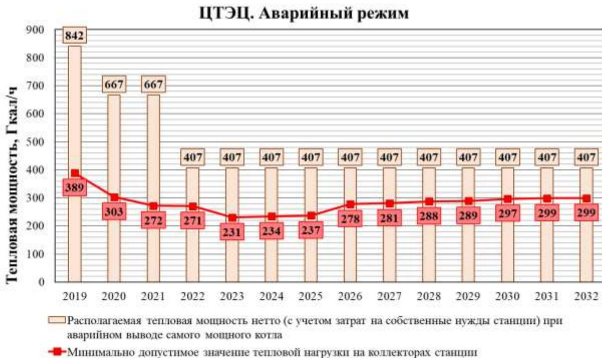
Рисунок 5.9 – Баланс тепловой мощности и подключенной нагрузки Центральной ТЭЦ в аварийном режиме
