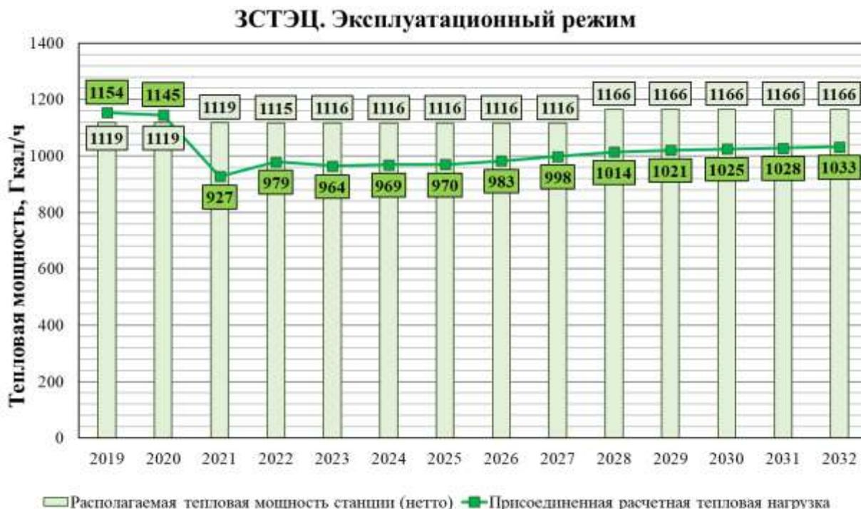
Рисунок 5.6 – Баланс тепловой мощности и подключенной нагрузки Западно-Сибирской ТЭЦ в эксплуатационном режиме
