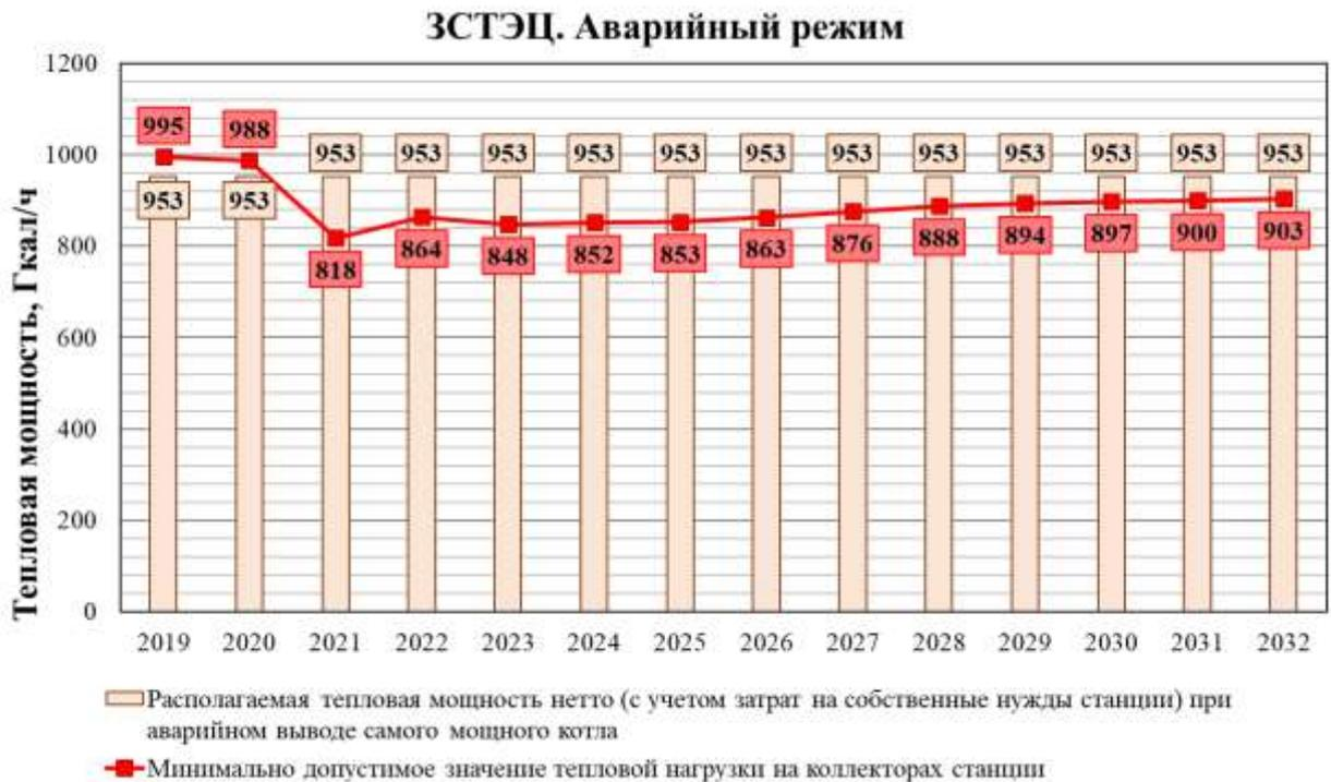
**Рисунок 5.7 – Баланс тепловой мощности и подключенной нагрузки Западно-Сибирской ТЭЦ в аварийном режиме**
